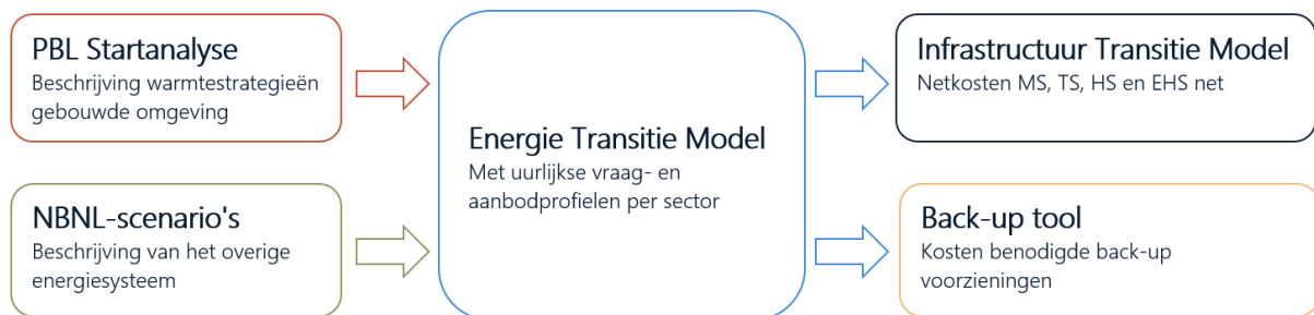
Figuur 2. Schematisch overzicht van het analyseproces: van Startanalyse en NBNL-scenario's via het ETM naar netkosten (ITM) en back-upkosten (back-uptool).
