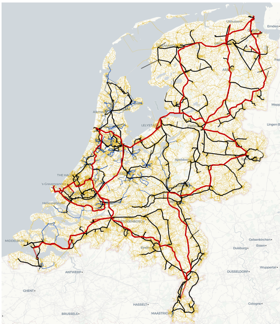
Figuur 8. Opgeschoonde liggingsgegevens van het EHS- (rood), HS- (zwart), TS- (blauw) en MS-net (geel).
